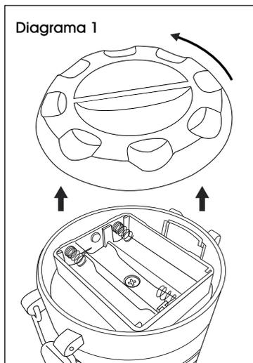
2. Coloque tres baterías AA con la polaridad adecuada.
