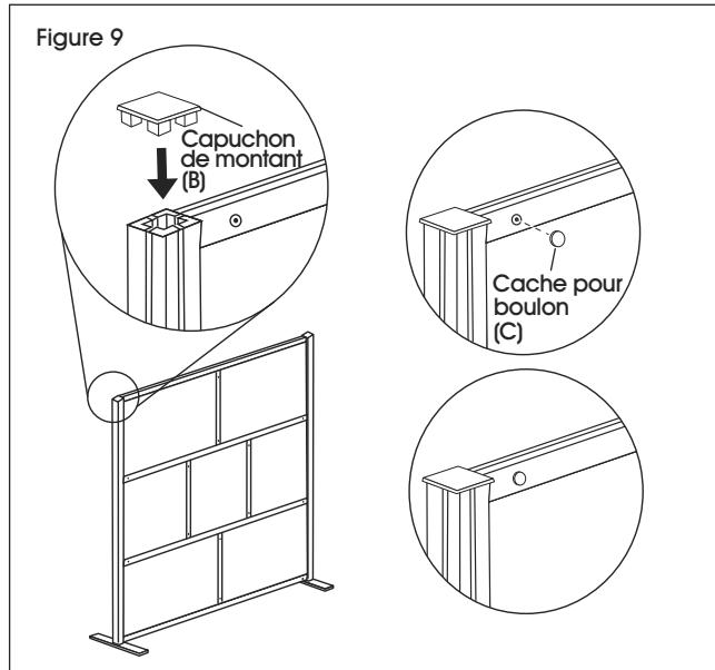
10. Installez les caches pour boulon sur les barres horizontales et verticales. (Voir Figure 9)
