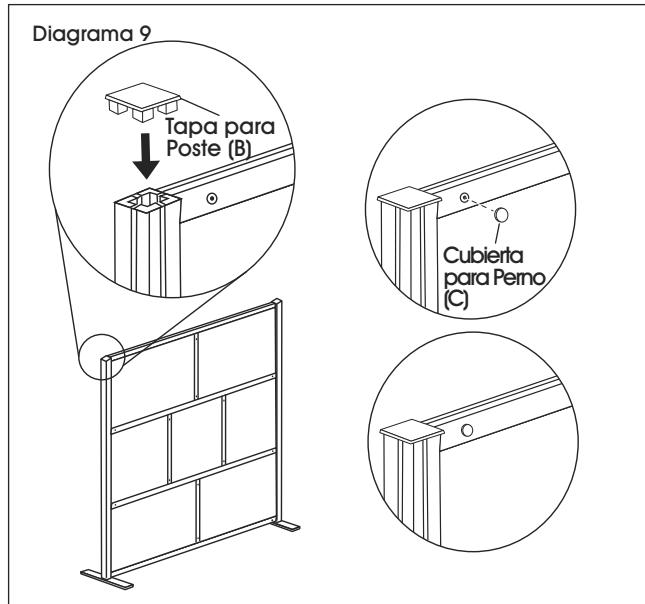
10. Coloque las cubiertas para perno en las barras horizontales y verticales. (Vea Diagrama 9)
