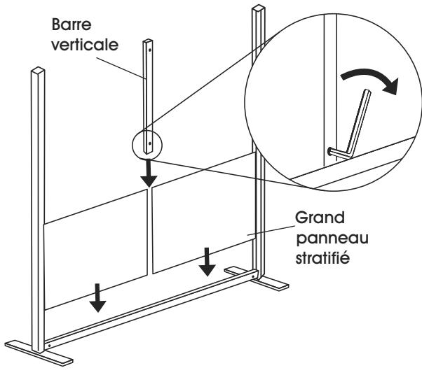
5. À deux, placez les petits panneaux stratifiés dans le cadre et faites glisser les barres verticales sur les petits panneaux stratifiés. Serrez les verrous du bas avec la clé Allen. (Voir Figure 5)
