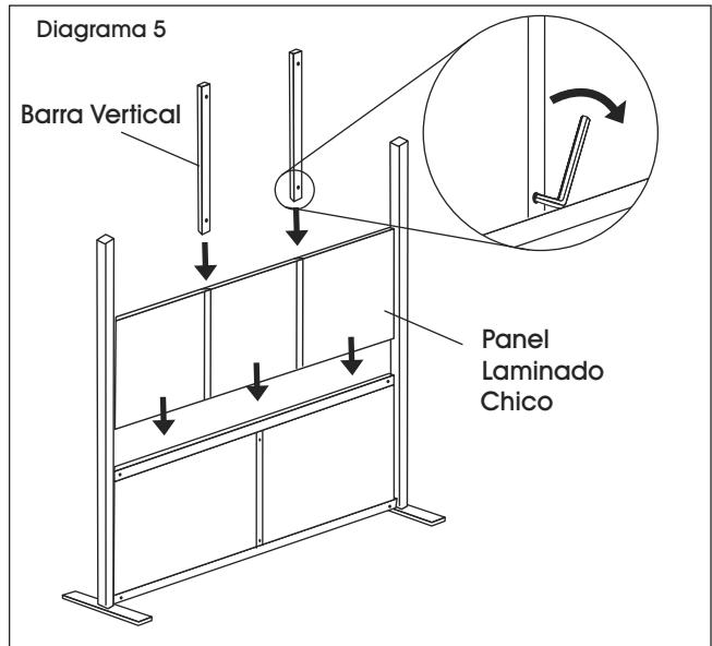
6. Inserte la barra horizontal entre los postes y deslícela hasta la hilera superior de los paneles. Apriete los seguros con la llave Allen.
