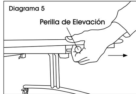
2. Levante la cubierta lentamente a la posición vertical. (Vea Diagramas 6-7)
