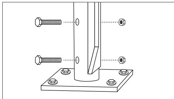
1. En utilisant les trous prépercés dans la base de l'ancrage à fixation comme modèles, marquez la position pour chacun des trous sur la surface en béton.
