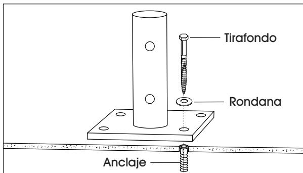
3. Vuelva a perforar con una broca de 3/4" para mampostería a la profundidad requerida para las bases.
