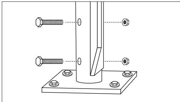
1. Utilizando como plantilla los orificios preperforados, marque la ubicación en la superficie del pavimento.
