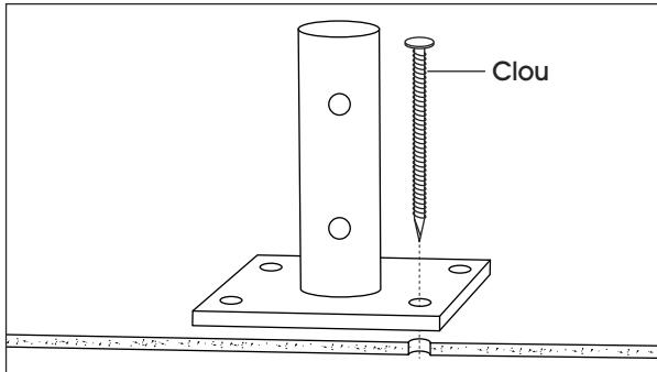
3. Assurez-vous que la surface est propre et sèche. Enfoncez chaque clou d'armature de 1/2 po à travers l'ancrage à fixation sur surface, puis dans le trou prépercé jusqu'à ce qu'il se loge fermement sur la base de l'ancrage.
