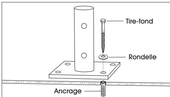
3. Percez de nouveau les trous avec une mèche à maçonnerie de 3/4 po afin d'atteindre la profondeur nécessaire pour les ancrages.
