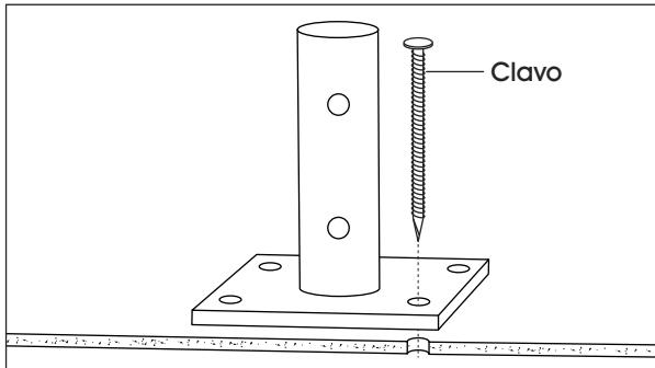
1. Utilizando como plantilla los orificios preperforados de la base, marque la ubicación en la superficie de asfalto.
