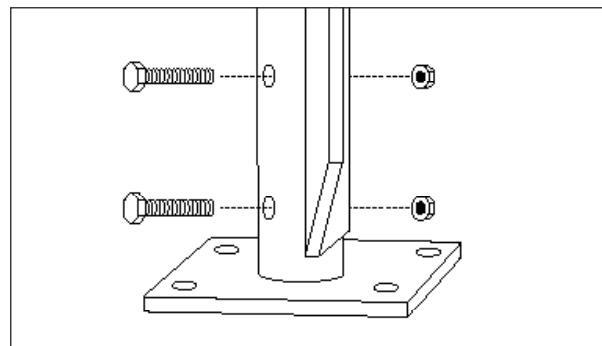
1. En utilisant les trous prépercés dans la base de l'ancrage à fixation comme modèles, marquez la position pour chacun des trous sur la surface asphaltée.
