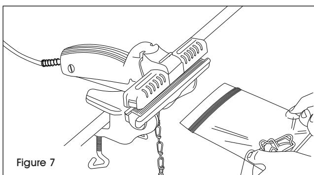
4. Si vous n'utilisez pas la pédale, insérez le sac dans la scelleuse et serrez la poignée de l'appareil. Maintenez la pression pour sceller le sac. (Voir Figure 8)
