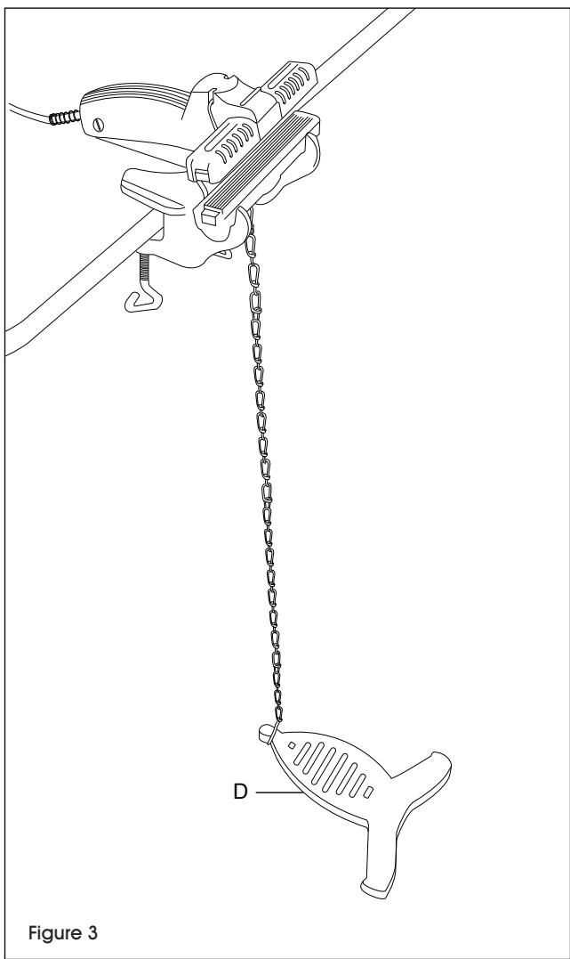
2. Fixez la chaîne à maillons en argent (B) au support à mâchoire (C). En tenant les mâchoires de scellage ensemble, poussez les tiges du support à mâchoire vers le haut à partir du bas de la scelleuse jusqu'à ce qu'elles s'enclenchent dans les canaux sur le dessus de l'appareil. Positionnez le support le plus près possible des mâchoires de scellage. (Voir Figure 2)
