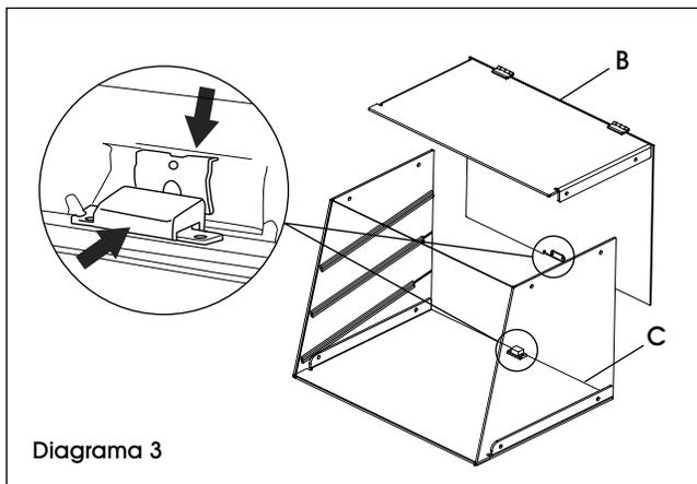
5. Alinee el canal de la parte superior y posterior con bisagras (B) con el frente (D) para asegurar el frente del exhibidor. El panel frontal (D) se debe ajustar de manera segura en los canales de todos los cuatro bordes. (Vea Diagrama 4)
