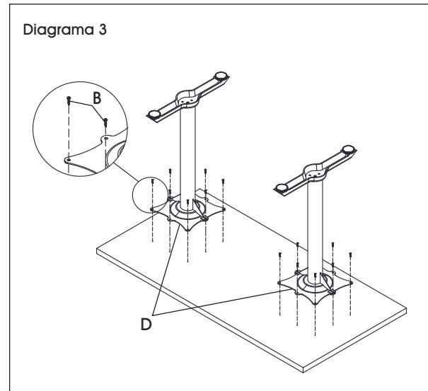
4. Con la ayuda de otra persona, enderece la mesa. Ajuste las patas niveladoras para compensar el desnivel en el piso.
