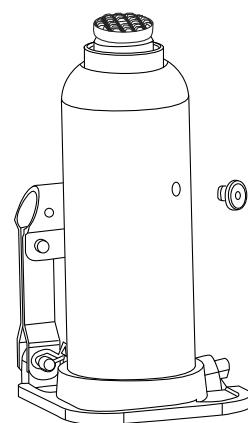
3. Remplissez le carter d'huile jusqu'à ce que le niveau d'huile soit juste en dessous du bord inférieur de l'orifice de remplissage d'huile. (Voir Figure 10)
