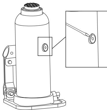
4. Mueva el asa de nuevo en la válvula de liberación y gire en sentido de las manecillas del reloj a la posición cerrada. (Vea Diagrama 4)
