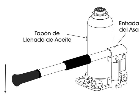
3. Con un desarmador plano, empuje el tapón de llenado de aceite hacia un lado para purgar el aire atrapado del sistema. (Vea Diagrama 3)
