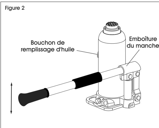
3. Poussez légèrement le bouchon de remplissage d'huile vers le côté avec un tournevis à lame plate pour purger l'air emprisonné dans le système.
