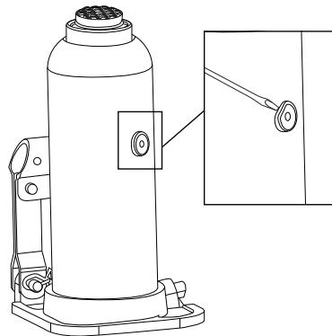
4. Replacez le manche dans la soupape d'évacuation et tournez-le dans le sens horaire en position fermée.
