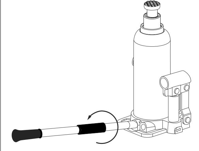
2. Una vez se remueva, empuje las asas del gato para tráiler hasta que esté completamente bajado. Esto protege el cilindro hidráulico del óxido y la suciedad.
