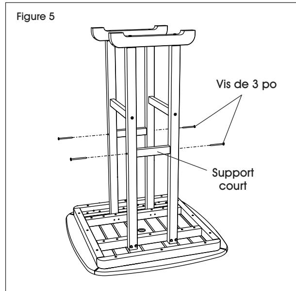
4. Fixez un support long entre deux pieds perpendiculaires à la base avec deux vis de 3 po.
