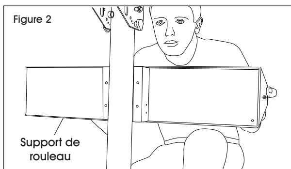
2. Placez la petite plaque du support de rouleau sur le côté opposé du pied. Alignez les quatre trous de vis du support de rouleau et de la petite plaque du support de rouleau. Vissez fermement pour fixer le support de rouleau sur le pied à l'aide d'une perceuse ou d'un tournevis cruciforme. (Voir Figure 3)
