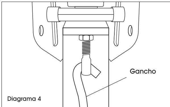
2. Deje caer el extremo en forma de T a través de la ranura abierta del pedal y gírelo para tratarlo en las pequeñas muescas en la parte inferior del pedal. (Vea Diagrama 5)
