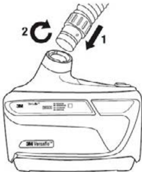
Figure 7: Como remover a traqueia
