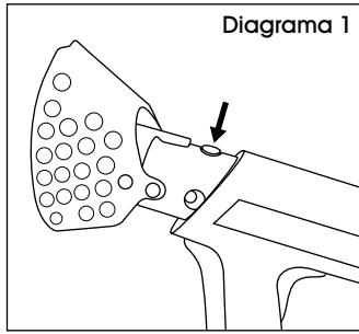
2. Conecte la cámara de combustión en el extremo de la extensión y confirme que quede firme en su lugar. El botón #31 debe sobresalir del orificio de la cámara de combustión cuando está asegurado.
