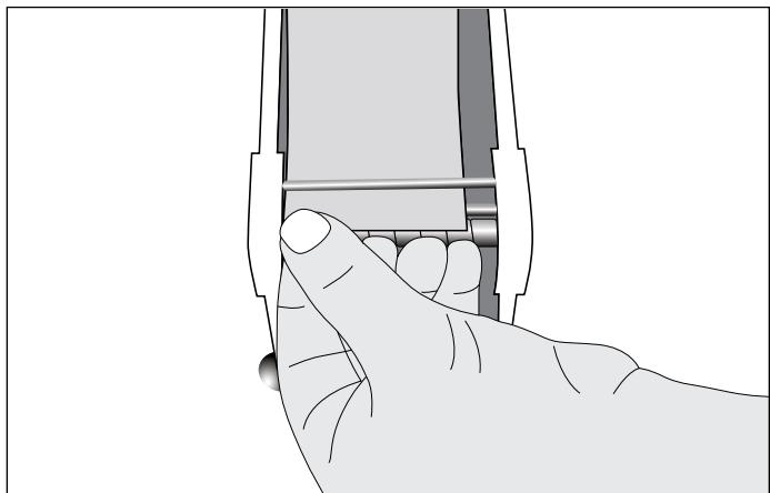
3. Inserte el respaldo entre la barra segundo y la barra tercero enroscada.
