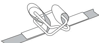
4. Insérez la partie supérieure du cerclage dans la fente du mécanisme de coupe et du bourriquet. Tenez l'outil et le cerclage de la main gauche et déplacez le levier à tension vers l'avant et l'arrière jusqu'à ce que le cerclage soit tendue. (Voir Figure 4)
