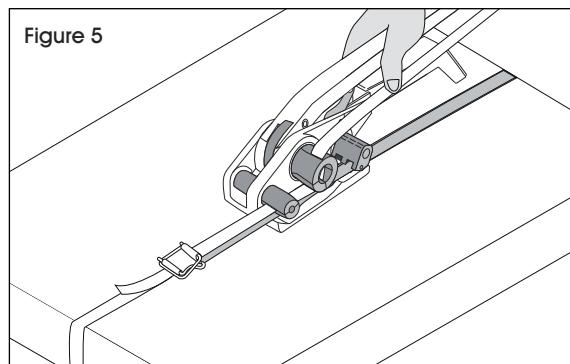
3. Prenez le tendeur de la main droite et relâchez le levier à tension. Placez le cerclage sous la pince pour qu'elle touche le boîtier du rebord de la main droite. Relâchez le levier à tension. (Voir Figure 3)
