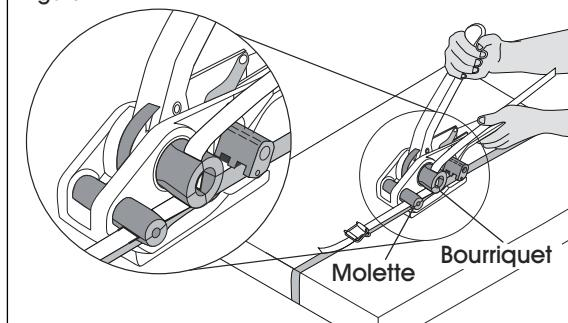
2. Placez le cerclage et la boucle autour du paquet et serrez manuellement le cerclage. (Voir Figure 2)
