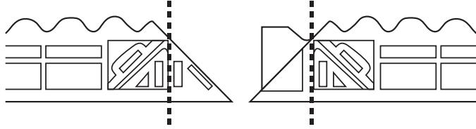
5. Quite la pestaña de conexión del extremo (Vea Diagrama 6) y úsela para fijar las rampas donde coinciden usando los orificios de la parte inferior (Vea Diagrama 7). Para las esquinas interiores, use este mismo método, pero corte por la línea marcada como "B" en ambos extremos.
