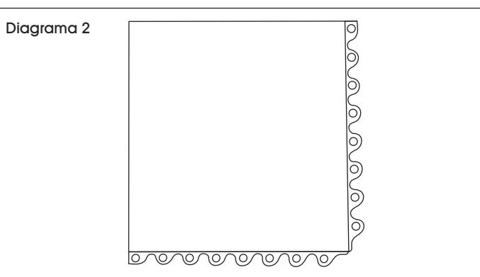
2. Coloque el segundo cuadro junto al primero, con los orificios del segundo apuntando hacia los tachones del primero. Inserte los tachones en los orificios ejerciendo presión. Continúe instalando más cuadros de tapete una fila cada vez, insertando los tachones en los orificios ejerciendo presión. (Vea Diagrama 3)
