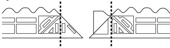
5. Retirez la languette de raccordement de l'extrémité de la bordure précédemment découpée (Voir Figure 6) et utilisez-la pour fixer les bordures de finition là où elles se rencontrent grâce aux emboîtures du dessous (Voir Figure 7). Pour les coins intérieurs, procédez de la même façon, mais en coupant le long de la ligne « B » sur les deux extrémités des bordures.
