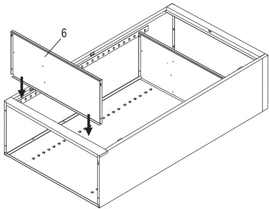
7. Inserte el separador (7) en el gabinete. Alinee los dos orificios superiores e inferiores del separador con los orificios de la parte superior de la repisa y de la parte inferior del gabinete. Fije con pernos y tuercas. (Vea Diagrama 6)
