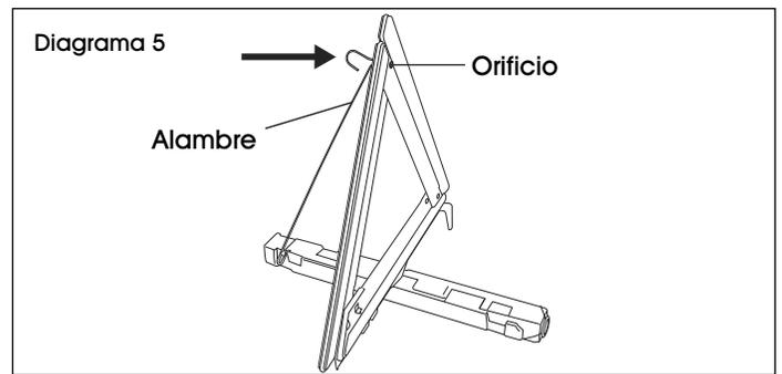
5. Coloque el/los triángulo(s) tal y como se muestra en el diagrama a continuación, mirando al tráfico. (Vea Diagrama 6)
