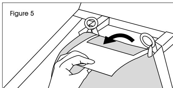
5. Placez une main sur le dessus de la recharge. Tout en maintenant les couvre-chaussures, retirez les languettes orange une à la fois. (Voir Figure 6)
