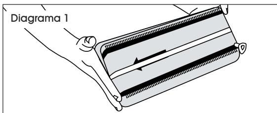
2. Alinee los clips azules con las ranuras del riel con la flecha apuntando hacia abajo. Asegúrese de que todos los clips entren en las ranuras con la punta redonda en el exterior del riel. (Vea Diagramas 2-3)
