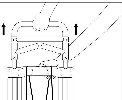
4. Para extender las asas plegables, jálelas hacia usted. Use la cuerda elástica para asegurar la carga. (Vea Diagrama 4)
