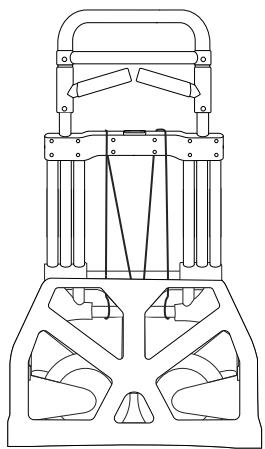
3. Incline el diablito hacia usted con las llantas ligeramente levantadas del suelo. Presione la base para extender las llantas. (Vea Diagrama 3)
