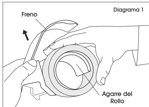
2. Jale 2-3" de cinta del rollo aplicando tensión al freno para sostenerlo. Jale la pestaña del extremo principal para pasar la cinta por la ranura guía. (Vea Diagrama 2)
