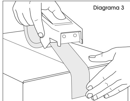
2. Jale el despachador por la parte superior de la caja, sobre la unión central. Aplique presión manual sobre el freno para tensar la cinta para obtener un sellado hermético. Presione la cinta con la mano opuesta. (Vea Diagrama 4)
