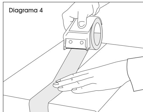
3. Continúe encintando el lado de la caja al largo deseado. Para cortar la cinta, presione y gire el despachador hasta que la navaja la corte. Presione la cinta con la mano. (Vea Diagrama 5)
