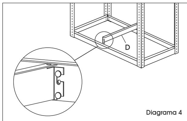
4. Fije la repisa superior (D) en el nivel inferior colocando las ranuras perforadas (en el soporte de la repisa) sobre los remaches (en el soporte frontal/posterior) y golpee para ponerlos en su lugar. (Vea Diagrama 4)
