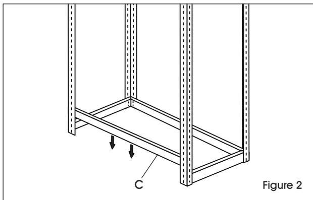
2. Reliez les deux ensembles de montants verticaux en insérant les supports avant/arrière (C) au bas des montants verticaux. (Voir Figure 2)
