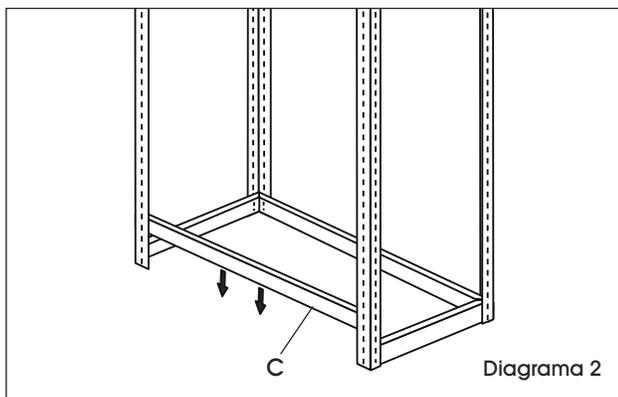
2. Conecte los ensambles de los dos postes verticales insertando los soportes frontales/posteriores (C) en la parte inferior de los postes verticales. (Vea Diagrama 2)
