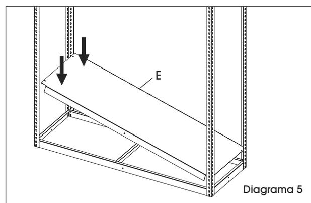
5. Coloque la parte inferior de la repisa de acero (E) en el soporte de repisa para que los bordes frontales y posteriores se traslapen en los soportes frontales/posteriores. (Vea Diagrama 5)
