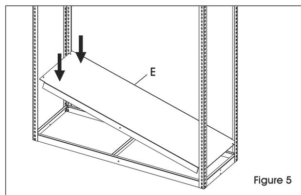
5. Déposez la tablette d'acier du bas (E) sur le support de tablette de façon à ce que les rebords avant et arrière chevauchent les supports avant/arrière. (Voir Figure 5)
