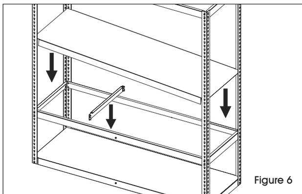
6. Installez des supports avant/arrière au niveau suivant voulu. Fixez le support de tablette, puis déposez la tablette en acier sur les supports de tablette. (Voir Figure 6)
