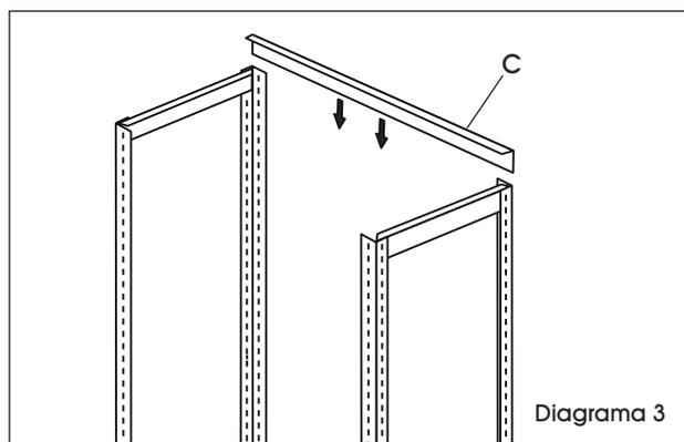
3. Conecte la parte superior de los dos ensambles de postes verticales insertando un soporte frontal/posterior (C). (Vea Diagrama 3)
