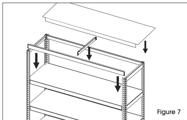
7. Fixez le support avant/arrière et le support de tablette restants. Déposez la dernière tablette en acier sur les supports de tablette. Fixez la tablette avec des boulons et écrous. (Voir Figure 7)
