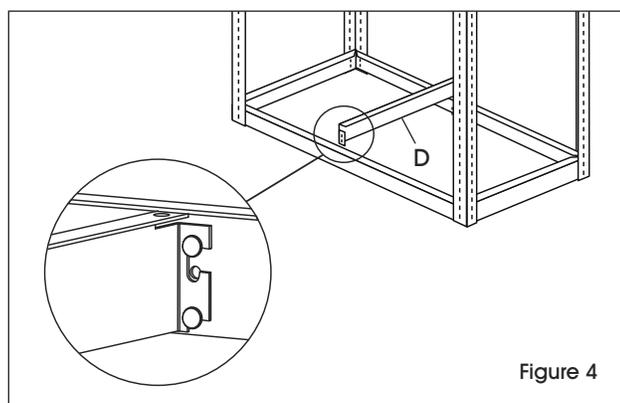
4. Fixez un support de tablette (D) à chaque niveau en plaçant les fentes (du support de tablette) sur les rivets (sur le support avant/arrière) et en les tapotant en place. (Voir Figure 4)
