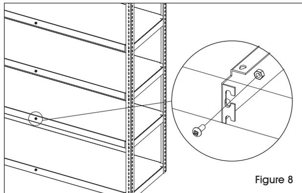
8. Une fois que les étagères sont en place, pour une stabilité supplémentaire si désiré, fixez-les à l'aide de boulons et d'écrous. (F). Serrez fermement. (Voir Figure 8)
