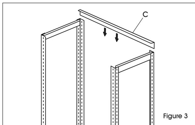
3. Reliez le haut des deux ensembles de montants verticaux en insérant un support avant/arrière (C). (Voir Figure 3)
