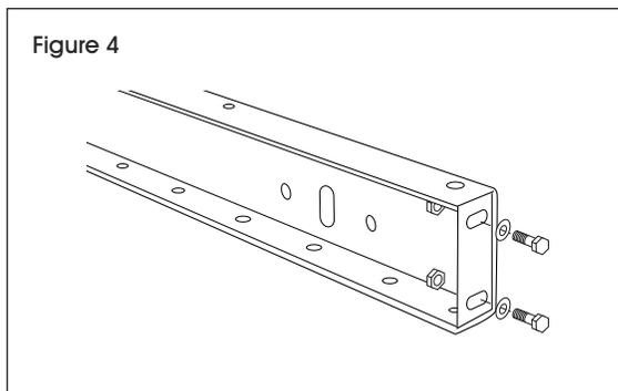
2. Fixez les boulons à travers les extrémités des deux cadres de convoyeur, utilisant les mêmes trous qu'à leur livraison. (Voir Figure 5)
