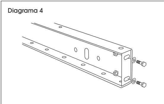
2. Ajuste los pernos a través de los extremos de ambos marcos de transportadora, utilice los mismos orificios con que llegaron. (Vea Diagrama 5)
