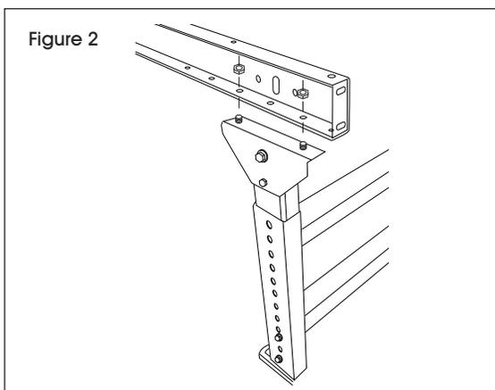
3. Boulonnage d'un seul pied de soutien en H à deux cadres de convoyeur : Positionnez le pied de soutien en H sous la jonction des extrémités des deux cadres de convoyeur, en alignant un trou de chaque convoyeur sur le pied de soutien en H. Fixez les boulons à travers les convoyeurs et le pied de soutien en H. (Voir Figure 3)
