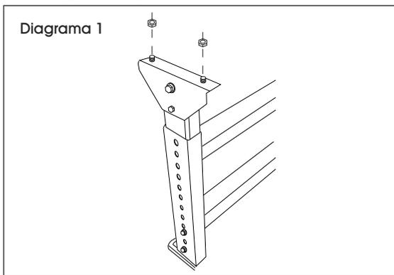
2. **Atornille dos Soportes en H a un marco de la transportadora:** Posicione el Soporte en H en el extremo del marco de la transportadora, alinee con los dos orificios en el extremo. Apriete los pernos a través de la transportadora y los Soportes en H. (Vea Diagrama 2)
