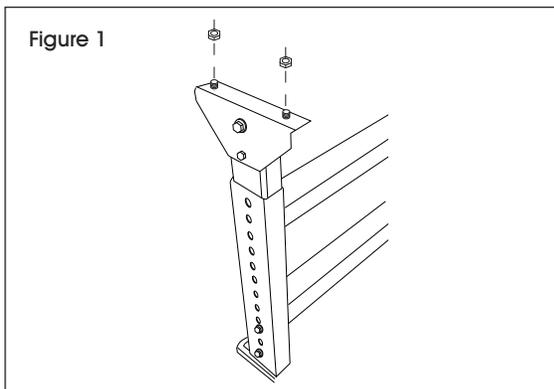
2. Boulonnage de deux pieds de soutien en H à un cadre de convoyeur : Positionnez les pieds de soutien en H à l'extrémité du cadre de convoyeur, en les alignant sur les deux trous à l'extrémité. Fixez les boulons à travers le convoyeur et le pied de soutien en H. (Voir Figure 2)
