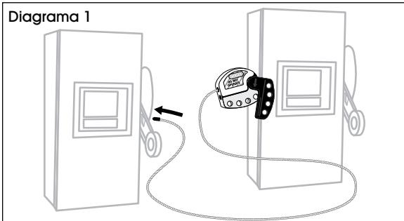
2. Lleve el extremo del cable hasta el segundo dispositivo. (Vea Diagrama 2)
