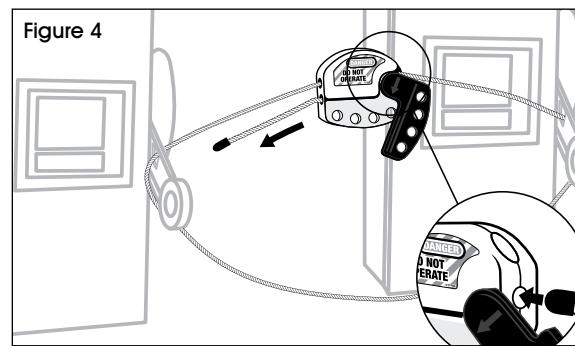
5. Fermez la poignée de verrouillage et tirez le câble jusqu'à ce qu'il soit tendu. Insérez le cadenas et fixez-le. (Voir Figure 5)
