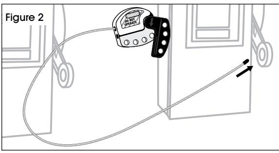
3. Enfilez le câble à travers le côté extérieur du deuxième appareil. (Voir Figure 3)
