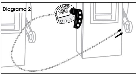
3. Inserte el cable en dirección opuesta a usted a través del segundo dispositivo. (Vea Diagrama 3)
