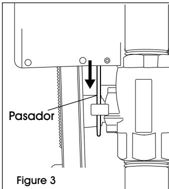
3. Deslice la abrazadera gris hasta que esté fijada alrededor de la válvula. (Vea Diagramas 4 y 5)
