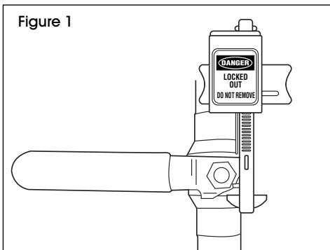
2. Deslice el pasador hacia abajo a través del espacio entre el asa de operación y el cuerpo de la válvula. (Vea Diagramas 2-3)
