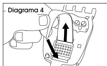
2. Inserte el fleje dentado a través de ambas lengüetas dentadas y coloque el extremo del bolsillo en el mecanismo de bloqueo. (Vea Diagrama 4)
