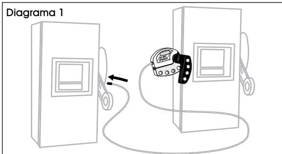
4. Inserte el extremo del cable en el dispositivo bloqueador. (Vea Diagrama 4)
