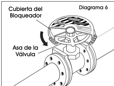
3. Asegure el/los candado(s) de bloqueo de seguridad insertando el/los eslabón(es) a través de los ojales de bloqueo superpuestos. (Vea Diagrama 7)
