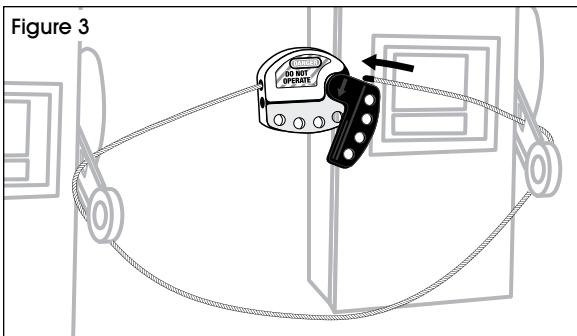
4. Insérez l'extrémité du câble dans le dispositif de cadenassage. (Voir Figure 4)
