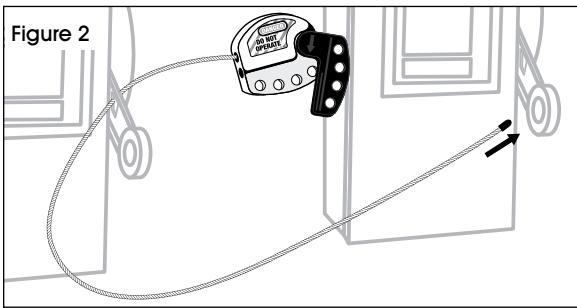
3. Enfilez le câble à travers le côté extérieur du deuxième appareil. (Voir Figure 3)
