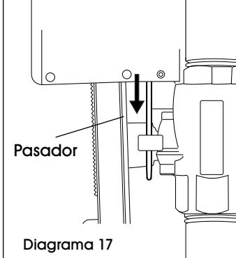
3. Deslice la abrazadera gris hasta que quede fija alrededor de la válvula. (Vea Diagramas 18 y 19)
