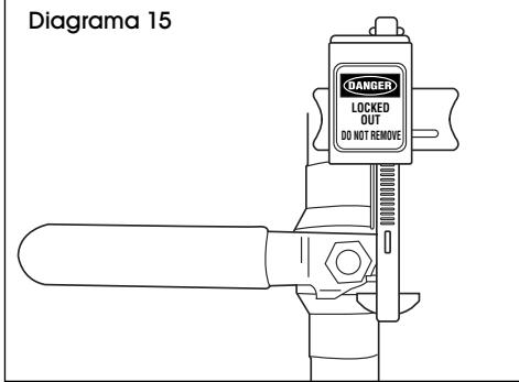
2. Deslice el pasador hacia abajo a través del espacio entre el asa de operación y el cuerpo de la válvula. (Vea Diagramas 16 y 17)
