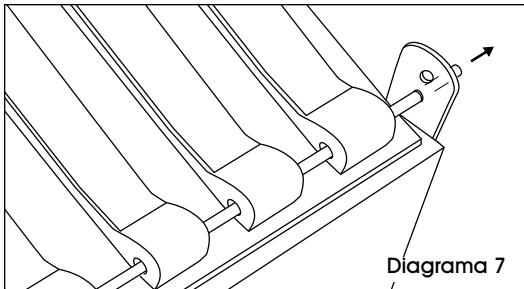
15. Siga los pasos 10-13 para colocar la barra de bloqueo, con la excepción de que la barra de bloqueo debe insertarse en el orificio superior del soporte. (Vea Diagrama 11)
