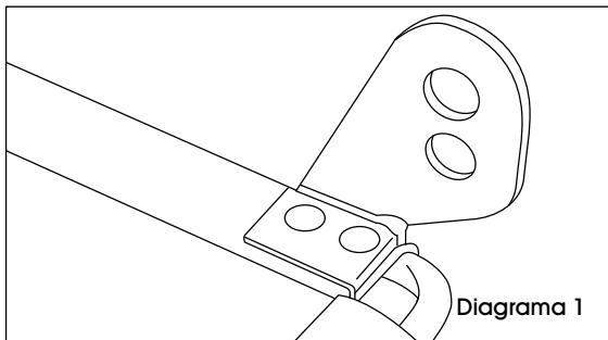
2. Marque los centros de los dos orificios de la parte inferior del soporte. Quite el soporte y taladre dos orificios de 0.95 cm (3/8") en el reborde de la tolva.
