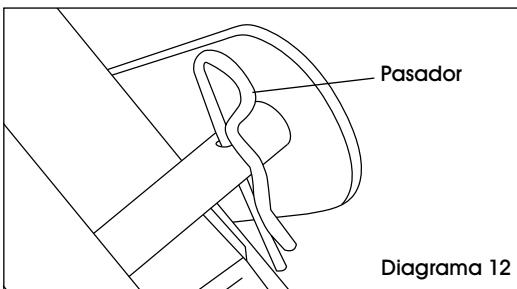
13. Cuando el tope despeje el soporte, empújelo hacia abajo y alinee la barra con el orificio del soporte. Deje que la barra se deslice a través del orificio inferior del soporte.
