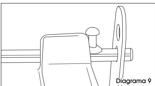
14. Inserte el pasador a través del orificio de la barra cercano al soporte de bisagra derecho.
