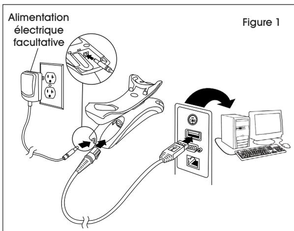
2. Assurez-vous que le câble est fixé dans les chemins de câbles dans la partie inférieure de la base et que la base repose à plat sur une surface horizontale. Le scanner émettra un signal sonore.
