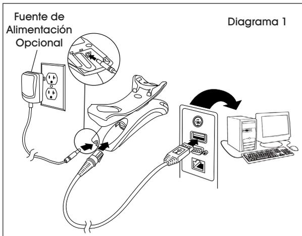
2. Asegúrese de que el cable esté bien sujeto a las ranuras de la parte inferior de la base y que la base quede plana sobre una superficie horizontal. El escáner emitirá un pitido.
