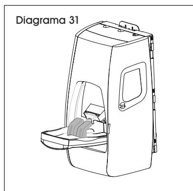
6. Para volver a armar la unidad, cierre la puerta delantera. Escuchará un clic que confirma que la boquilla está colocada y la alarma reactivada. (Vea Diagrama 32)
