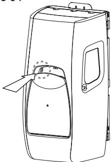
panneau avant et déposez-le sur une surface plane, la face interne orientée vers le haut. (Voir Figure 36)
