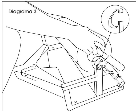
2. Inserte el tubo de soporte en el núcleo del rollo.
