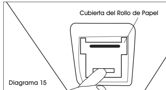
2. Inserte el rollo de papel. Inserte el extremo del rollo de papel a través de la cubierta. (Vea Diagrama 16)
