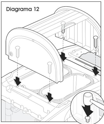
16. Coloque la cubierta de seguridad con cerradura en la parte superior de la repisa. Luego inserte los pernos en las cuatro ubicaciones dentro de la tapa, como se muestra. Utilice un mazo de caucho para asegurarlos en su lugar. (Vea Diagrama 12)
