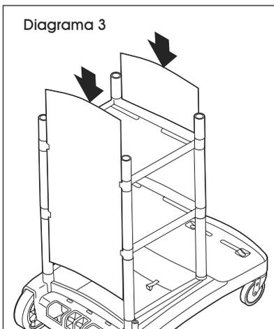
6. Deslice dos paneles laterales en los lados del carrito, como se muestra. (Vea Diagrama 3)
