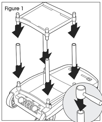
1. Placez quatre longs montants en aluminium sur les chevilles de la base. Utilisez le maillet en caoutchouc pour fixer en place. (Voir Figure 1)
