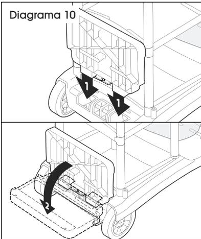
14. Inserte a presión la plataforma de la cubeta del trapeador hacia abajo en su lugar y luego baje la plataforma a su posición. (Vea Diagrama 10)
