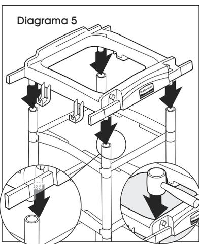
9. Coloque la repisa superior abierta a través de los postes cortos de aluminio. Utilice un mazo de caucho para asegurarlos en su lugar. (Vea Diagrama 5)
