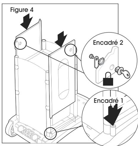
7. Faites glisser les panneaux de porte sur les deux autres côtés du chariot en vous assurant que le bas s'aligne correctement sur les trous. (Voir Figure 4) (Voir Encadré 1)
