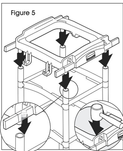
9. Installez la tablette supérieure ouverte sur les montants courts en aluminium. Utilisez le maillet en caoutchouc pour fixer en place. (Voir Figure 5)
