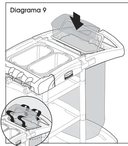
13. Coloque la bolsa de limpieza a través de la abertura del asa. (Vea Diagrama 9)
