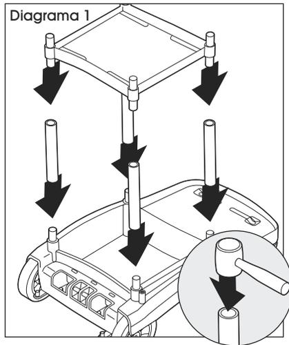
1. Coloque los cuatro postes largos de aluminio en las clavijas de la base. Utilice un mazo de caucho para asegurarlos en su lugar. (Vea Diagrama 1)
