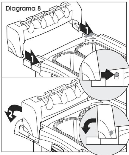
12. Deslice el soporte para herramientas en el lado opuesto del asa y rótelo hacia abajo para asegurarlo en su lugar. (Vea Diagrama 8)
