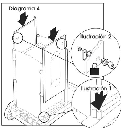
7. Deslice los paneles de la puerta hacia abajo por los otros dos lados del carrito, asegurándose de que la parte inferior se alinee correctamente con los orificios. (Vea Diagrama 4) (Vea Ilustración 1)
