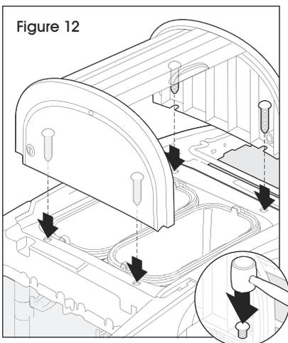
16. Installez le couvercle de sécurité verrouillable sur la tablette ouverte. Insérez ensuite les boulons dans les quatre emplacements comme illustré. Utilisez le maillet en caoutchouc pour fixer en place. (Voir Figure 12)
