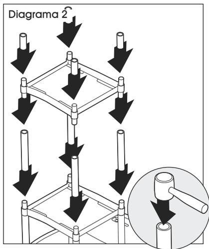
3. Coloque los cuatro postes largos de aluminio en las clavijas de la primera repisa. Utilice un mazo de caucho para asegurarlos en su lugar. (Vea Diagrama 2)
