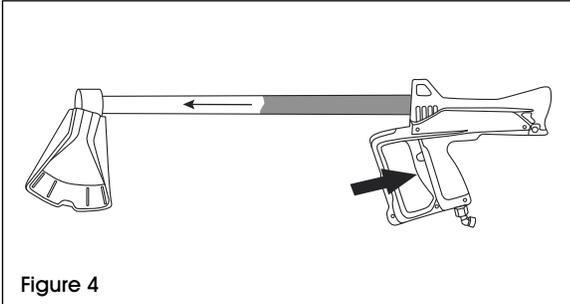
2. Après ce délai, appuyez à fond sur la détente pour déclencher le pistolet thermique. (Voir Figure 5)
