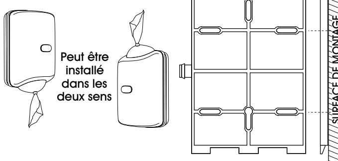
4. Alignez la plaque de montage au niveau souhaité sur le mur.
