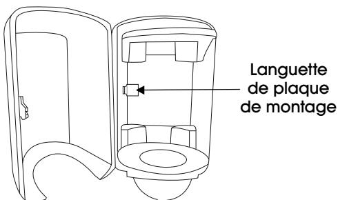
3. Déterminez le sens du distributeur : ouverture orientée vers le haut ou vers le bas. Faites attention au sens de la plaque de montage. (Voir Figure 2)
