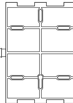
4. Alinee la placa de instalación en la posición deseada sobre la pared.
