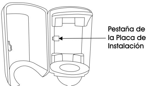
3. Determine la orientación del despachador: horizontal o al revés. Verifique la orientación de la placa de instalación. (Vea Diagrama 2)
