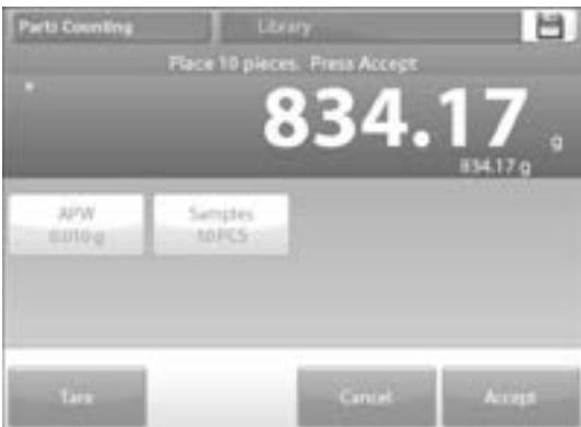
4. Para volver a la pantalla de inicio de conteo, pulse **RETURN TO APPLICATION (VOLVER A LA APLICACIÓN)**. La pantalla inicial muestra 10 piezas en el nuevo APW.
