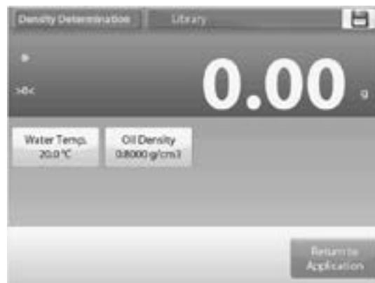
4. La balanza calcula la densidad del agua basado en el valor ingresado de temperatura del agua (tabla de búsqueda).
