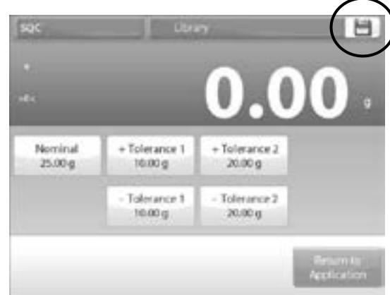
7. Aparece un mensaje de registro guardado. Presione **OK (BUENO)**, luego presione **RETURN TO APPLICATION (VOLVER A LA APLICACIÓN)**.
