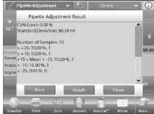
4. Presione **GRAPH (GRÁFICA)** para ver los resultados marcados. Presione **RESULT (RESULTADO)** para volver a la pantalla de resultados. Presione **CLOSE (CERRAR)** para volver a la pantalla de inicio de ajuste de pipeta.
