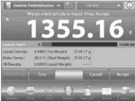
14. Una vez que los pesos necesarios se hayan determinado, la densidad de la muestra aparece en  $\text{g}/\text{cm}^3$  (al igual que el peso en aire, con y sin aceite y el peso en agua) en la pantalla de aplicación.
