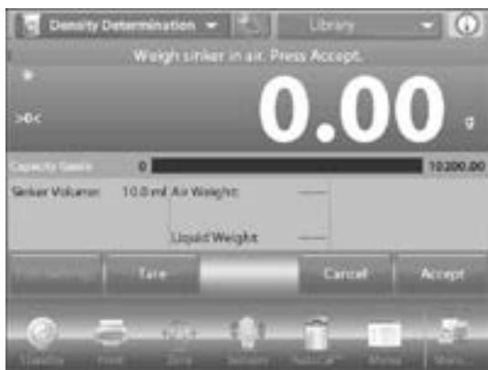
10. Pese el plomo sumergido en el líquido de prueba. Siga las instrucciones en la pantalla, luego presione **ACCEPT** para almacenar el peso del plomo (sumergido en líquido).
