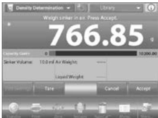
11. Après détermination des poids nécessaires, la densité de l'échantillon liquide est affichée en g/cm<sup>3</sup> (ainsi que le poids à l'air et le poids dans l'eau) sur l'écran de l'application.
