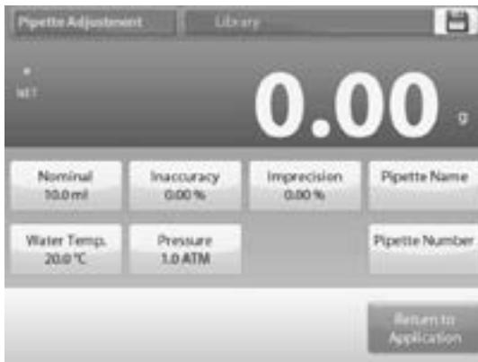
3. Una vez que todos los pesos de muestra se hayan despachado, la pantalla de resultados aparece automáticamente.
