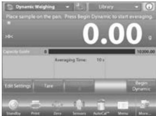
4. Despues que el ciclo termine, retire el espécimen. La balanza vuelve a la pantalla inicial automáticamente (después de un retraso de 10 segundos).
