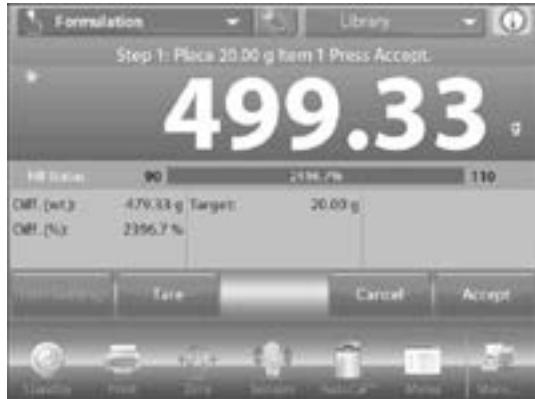
17. Le poids du composant s'affiche sur la ligne principale. La barre de progression indique le degré de remplissage et passe automatiquement au mode de résolution fine lorsque le remplissage se trouve à 10 % de la valeur cible.
