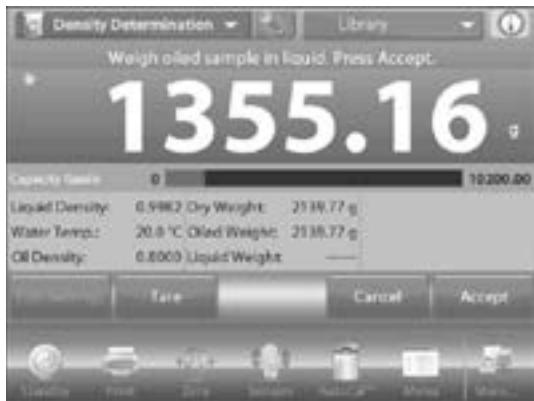
14. Après avoir déterminé les poids nécessaires, la densité de l'échantillon est affichée en g/cm<sup>3</sup> (ainsi que le poids à l'air, huilé, non huilé et le poids dans l'eau) sur l'écran de l'application.
