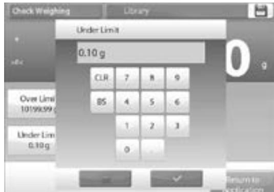
5. La pantalla vuelve a la anterior con el nuevo valor resaltado momentáneamente. Para volver a la pantalla de inicio de verificación de peso, pulse **RETURN TO APPLICATION**.
