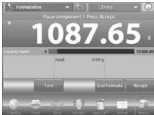
4. Una notificación indica que coloque el artículo 2. Presione **ACCEPT**. Continúe añadiendo componentes y presionando **ACCEPT** para almacenar el peso de los componentes individuales hasta que la fórmula esté completa.
