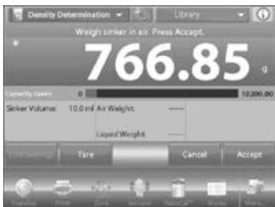
11. Una vez que los pesos necesarios se hayan determinado, la densidad de la muestra aparece en g/cm³ (al igual que el peso en aire, peso en agua) en la pantalla de aplicación.
