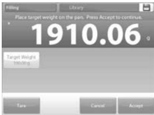
3. Coloque el peso en la bandeja (o en un contenedor con tara).
