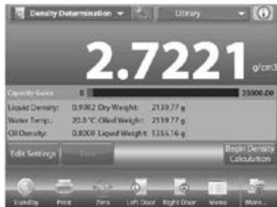
15. Presione **BEGIN DENSITY DETERMINATION** para reiniciar todos los valores de peso y el proceso.
