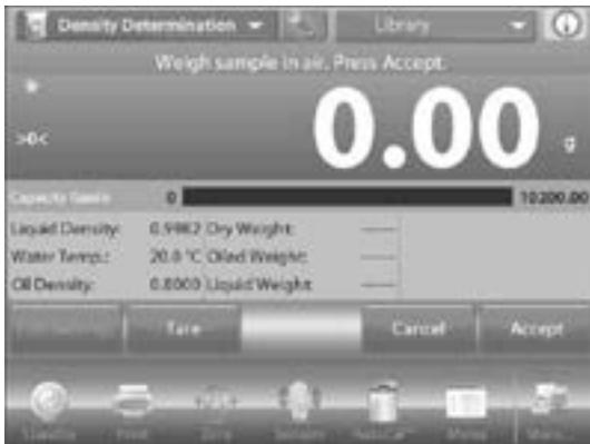
12. Pese la muestra con aceite en aire. Siga las instrucciones en la pantalla, luego presione **ACCEPT** para almacenar el peso de muestra (con aceite).
