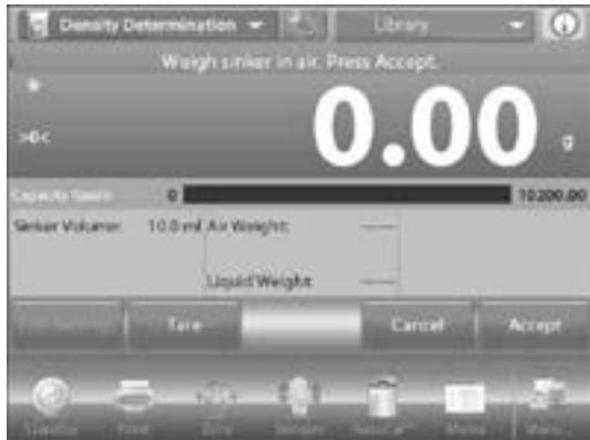
10. Pesez le plomb submergé dans le liquide d'essai. Suivez les instructions à l'écran, puis appuyez sur **ACCEPT** pour enregistrer le poids du plomb (submergé dans un liquide).
