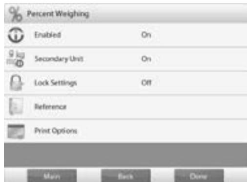
La balanza se puede configurar para funcionar en varios modos de aplicación. Pulse **APPLICATIONS (APLICACIONES)** para escoger – o el botón superior del área de aplicación.
