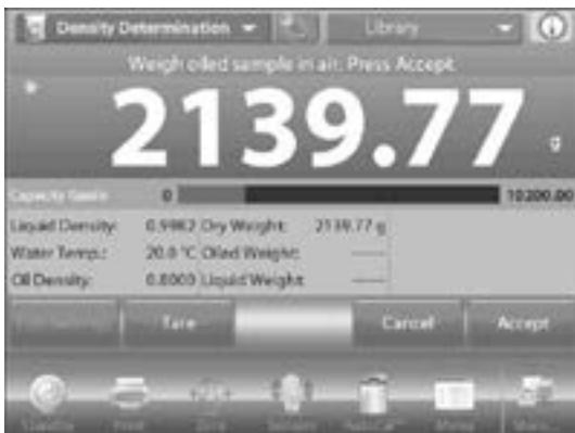
13. Pese la muestra con aceite sumergida en líquido. Siga las instrucciones en la pantalla, luego presione **ACCEPT** para almacenar el peso de muestra con aceite (sumergido en líquido).
