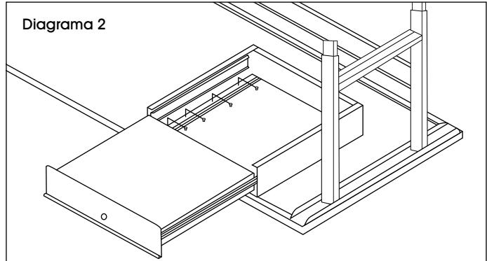
3. Cierre el cajón y coloque la mesa de trabajo en posición vertical. Abra y cierre el cajón varias veces para comprobar el funcionamiento.
