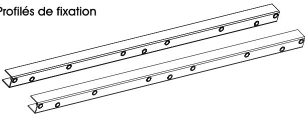
1. Retournez la table d'emballage. Sur le dessous de la table, faites glisser les profils de fixation de l'avant vers l'arrière dans les brides de la table. Une fois alignés, les profils doivent se situer à environ 23,5 po l'un de l'autre. Fixez chaque profilé à l'aide de deux boulons de 1/4 po-20 x 5/8 po. (Voir Figure 1)
