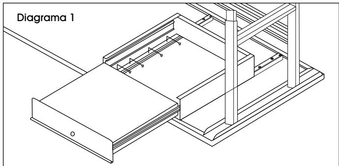
3. Cierre el cajón y coloque la mesa de trabajo en posición vertical. Abra y cierre el cajón varias veces para comprobar el funcionamiento.
