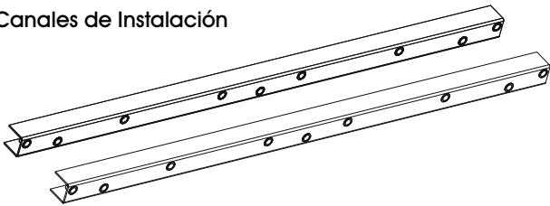
1. Voltee la mesa de trabajo. En la parte inferior de la mesa, deslice los canales de instalación de adelante hacia atrás para insertarlos en las pestañas de la mesa. Cuando los canales estén alineados, los orificios de instalación deberán quedar a 23 1/2" de distancia. Fije cada uno de los canales con dos pernos de 1/4"-20 x 5/8". (Vea Diagrama 1).
