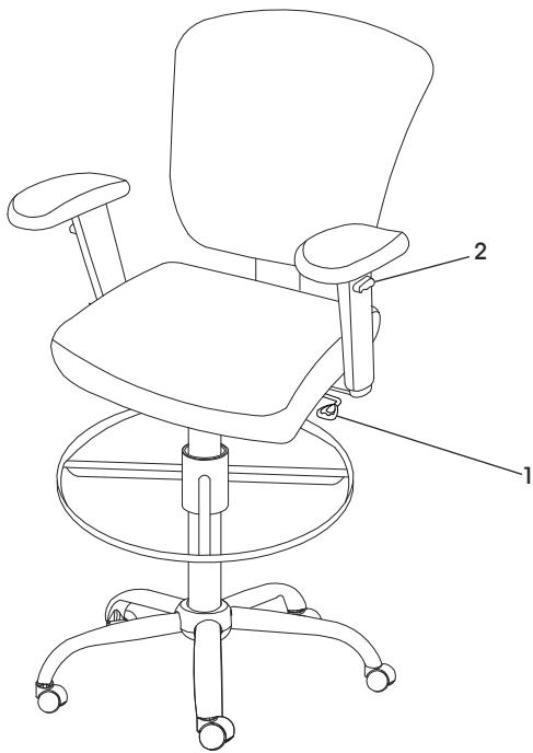
1. Ajuste de la Altura del Asiento – Para subir la altura del asiento, levante la palanca sin o con poco peso en el asiento. Para bajar la altura del asiento, levante la palanca mientras está sentado.
