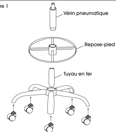
1. Insérez les roulettes ou les patins dans les pieds de la base à cinq branches. Tournez la base à l'endroit. Insérez le tuyau en fer dans le centre de la base. Placez le repose-pied sur le haut du tuyau en fer et insérez le vérin pneumatique dans le centre du repose-pied. (Voir Figure 1)
