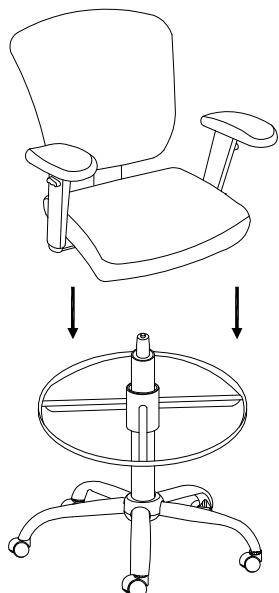
5. Baje lentamente el ensamble de la silla sobre el pistón de gas. Presione el asiento para asegurarlo. (Vea Diagrama 5)
