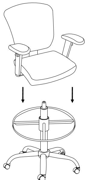
5. Abaissez lentement le tabouret sur le vérin pneumatique. Appuyez sur le siège pour le fixer. (Voir Figure 5)
