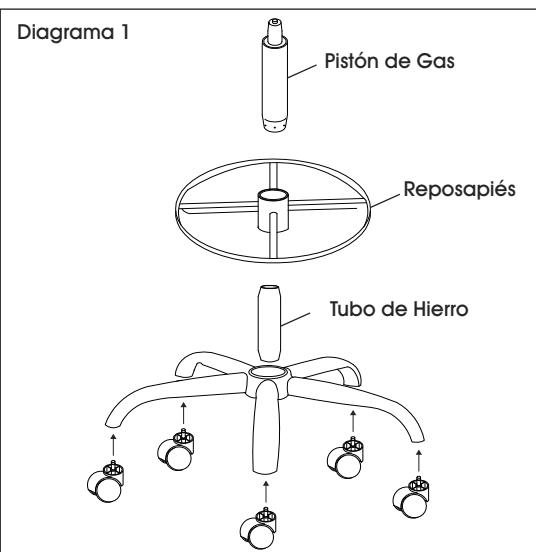
1. Inserte las ruedas o los niveladores en las patas de la base estrella. Enderece la base. Inserte el tubo de hierro en el centro de la base. Coloque el reposapiés encima del tubo de hierro y luego inserte el pistón de gas en el centro del reposapiés. (Vea Diagrama 1)
