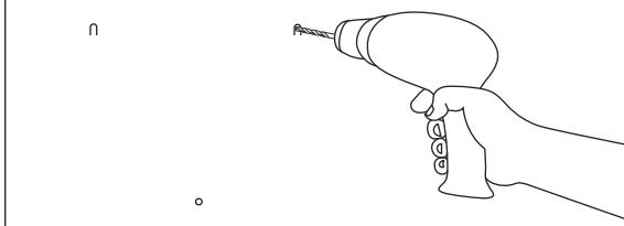
5. Tenez le distributeur au-dessus des trous prépercés et insérez les deux vis supérieures sans serrer complètement. Abaissez le distributeur tout en faisant glisser les vis dans la partie étroite des fentes. Serrez-les complètement. Insérez la vis inférieure.
