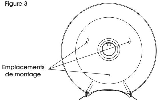
4. Percez le mur aux trois endroits marqués avec une mèche de perceuse de taille appropriée. (Voir Figure 4) Insérez les ancrages muraux si nécessaire.
