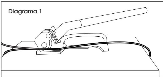
3. Apriete el mango hacia la base e inserte el fleje por debajo del sujetador.
