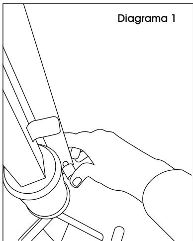
3. Si lo desea, ajuste la altura de las patas jalando la base hacia arriba hasta que los pasadores de bloqueo se deslicen a su segunda posición. (Vea Diagrama 3)
