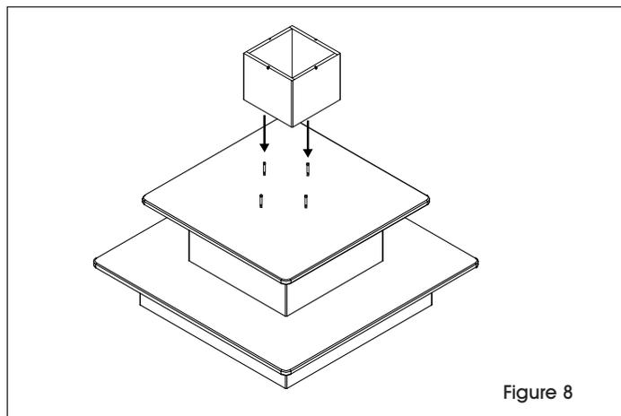
9. Enfoncez quatre courtes goupilles de cylindre à excentrique dans la tablette supérieure, et déposez-le au-dessus du support de tablette supérieure. Tournez les quatre vis extérieures dans le sens horaire pour fixer la tablette supérieure à son support. (Voir Figure 9)
