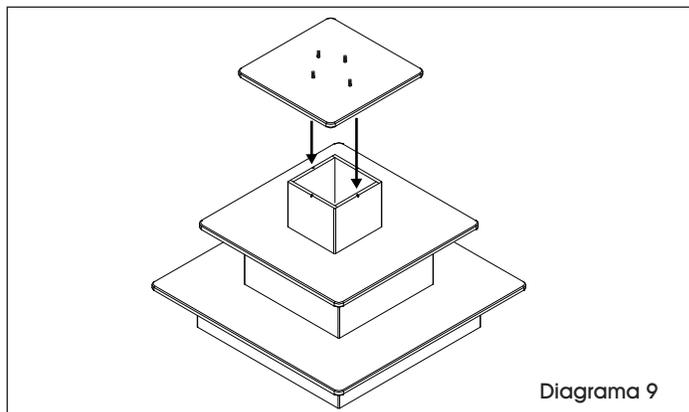
8. Coloque el ensamble de la caja superior sobre los cuatro pasadores de bloqueo largos de la mesa central. Inserte el desarmador en los cuatro pasadores de bloqueo insertados restantes en la parte inferior y gire en la dirección de las agujas del reloj para fijar el ensamble de la caja a la mesa. (Vea Diagrama 8)
