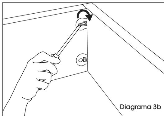
4. Coloque el ensamble de la caja inferior sobre los ocho pasadores de bloqueo largos de la mesa inferior. Inserte el desarmador en los ocho pasadores de bloqueo insertados restantes en la parte inferior y gire en la dirección de las agujas del reloj para fijar el ensamble de la caja a la mesa. (Vea Diagrama 4)
