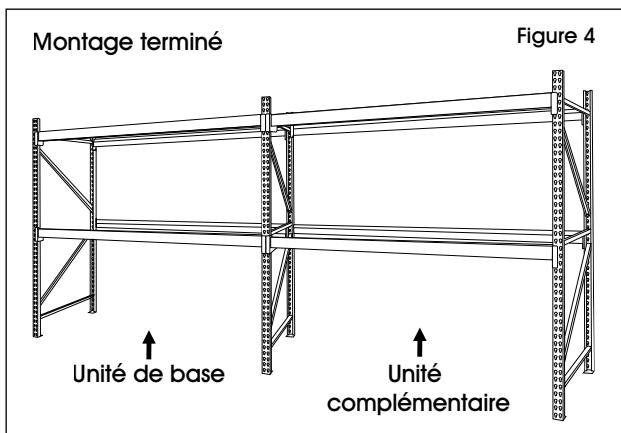
6. Insérez le reste des traverses de soutien dans les montants à la hauteur désirée. (Voir Figure 4)
