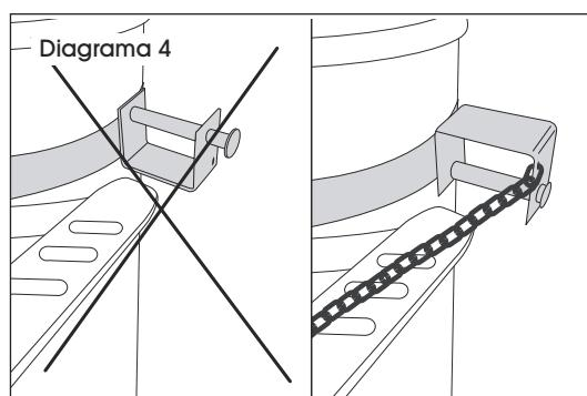
5. Fije las cadenas de seguridad del anillo de inclinación al montacargas para evitar que el anillo se resbale de las horquillas mientras se encuentre en uso.
