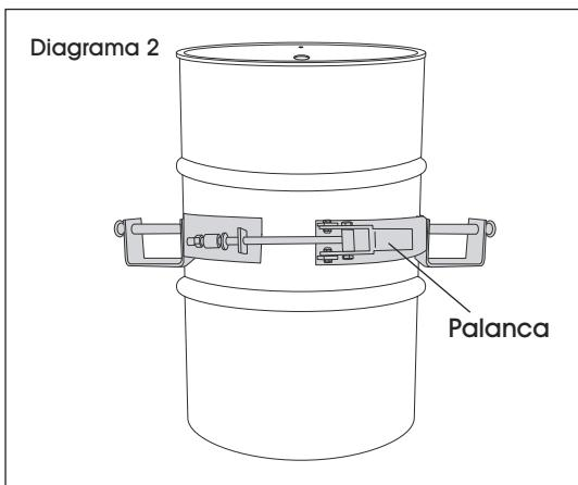
3. Apriete firmemente el anillo de inclinación alrededor del tambo utilizando el perno. (Vea Diagrama 3)
