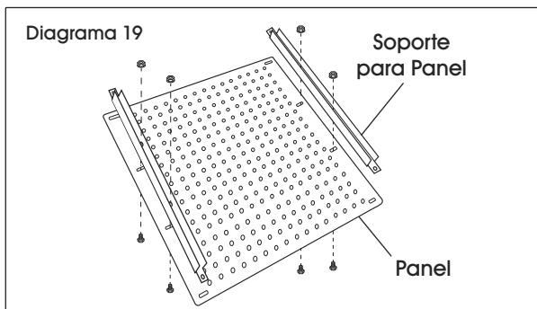
4. Repita con los paneles adicionales. La estación de trabajo de 48" soporta hasta 2 paneles, las estaciones de trabajo de 60" y 72" soportan hasta 3 paneles, y las de 96" soportan hasta 4 paneles.
