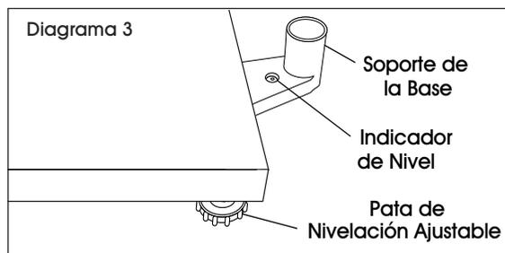
2. Use las patas de nivelación ajustables ubicadas en la parte inferior de la báscula hasta que la burbuja se muestre en el centro del indicador. (Vea Diagrama 4)
