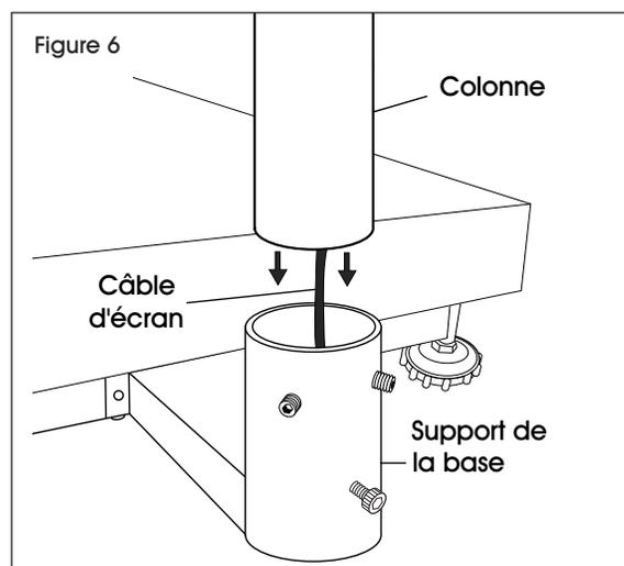
4. Sécurisez la colonne avec les vis de réglage à l'aide d'une clé Allen de 2 mm, et le boulon d'assemblage à six pans creux à l'aide d'une clé Allen de 4,5 mm, mais ne les serrez pas.
