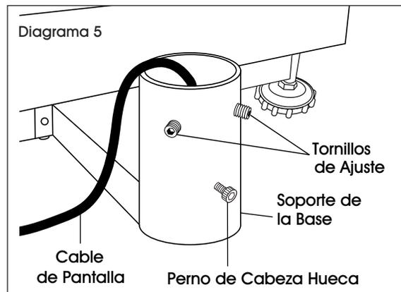
3. Introduzca la columna dentro de la base del soporte. Asegúrese que la columna reposa en la parte inferior del soporte de la base. (Vea Diagrama 6) Jale el cable de pantalla a través de la columna para que no quede holgado debajo de la plataforma.
