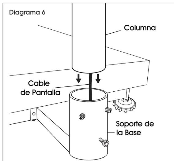
4. Asegure la columna con el juego de tornillos utilizando una llave Allen de 2 mm y con el perno de cabeza hueca utilice una llave Allen de 4.5 mm, pero no lo apriete.
