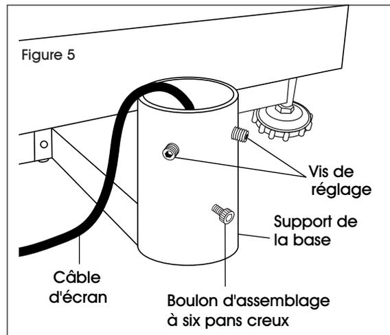
3. Insérez la colonne dans le support de la base. Assurez-vous que la colonne repose au bas du support de la base. (Voir Figure 6) Faites passer le câble d'écran dans la colonne de sorte qu'il ne soit pas lâche sous la plateforme.
