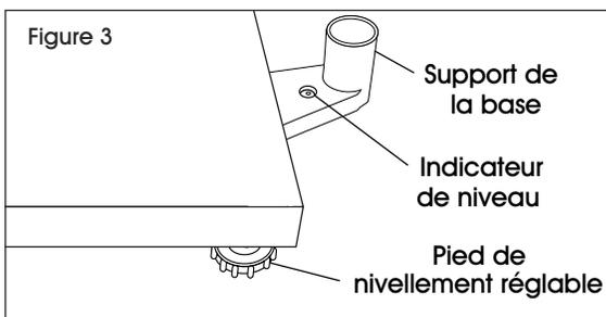
2. Ajustez les pieds de nivellement réglables situés en dessous de la balance jusqu'à ce que la bulle apparaisse au centre de l'indicateur. (Voir Figure 4)
