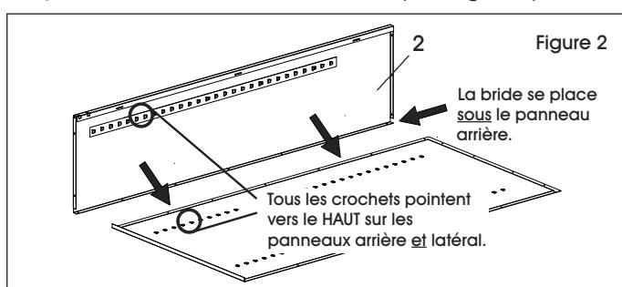
3. Fixez le panneau supérieur (7) à l'unité en glissant la bride extérieure par-dessus le panneau arrière de l'unité et la bride latérale sur le panneau latéral de l'unité. Les goujons filetés doivent s'insérer dans les trous de la bride supérieure du panneau latéral et être fixés à l'aide de trois écrous. Fixez le panneau arrière au panneau supérieur à l'aide de quatre boulons et écrous. (Voir Figure 3)
