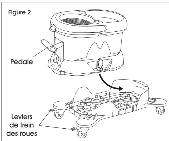
4. Pour bouger le socle, déverrouillez les roues en poussant les leviers de frein des roues vers le haut. (Voir Figure 4)
