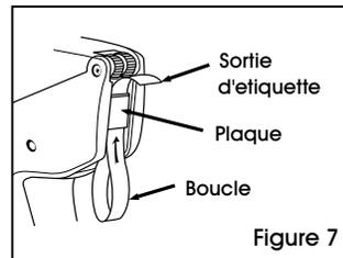
6. Faites glisser la bande d'étiquettes sous la plaque et tirez-la au travers jusqu'à ce que la boucle soit supprimée. (Voir Figure 7)
