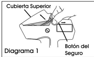
1. Empuje los dos botones del seguro hacia el rollo de etiquetas y la tapa de la cubierta abatible lejos de la cabeza de impresión. (Vea Diagrama 1)
