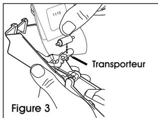
3. Coupez l'extrémité de l'emballage du rouleau encreur. En utilisant l'emballage pour protéger les doigts, faites glisser le transporteur dans l'emballage jusqu'à ce que le nouveau rouleau encreur s'enclenche. (Voir Figure 3)
