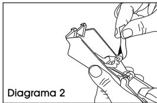
2. Inserte el papel de respaldo doblado entre el rodillo de tinta y el cargador. Jale para sacar el rodillo de tinta usado. (Vea Diagrama 2)
