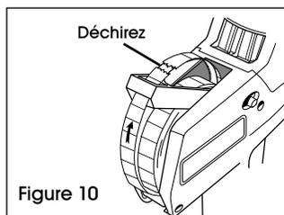
1. Déchirez la bande d'étiquettes au rouleau d'étiquettes comme indiqué, puis tirez sur le rouleau d'étiquettes entre les moyeux. (Voir Figure 10)
