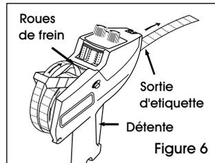
5. Pressez et maintenez la détente enfoncée tout en alimentant la bande d'étiquettes dans la fente sous les roues de frein, jusqu'à ce qu'environ 15 cm (6 po) sortent de l'avant. (Voir Figure 6)
