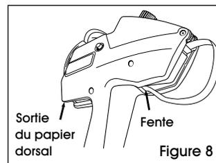
8. Maintenez la bande en place et appuyez sur la détente huit fois ou jusqu'à ce que le papier dorsal émerge de la sortie arrière.
