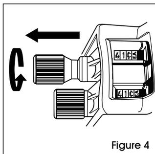
1. Tirez sur le bouton jusqu'à ce que les indicateurs soient sur la bande désirée. (Voir Figure 4)
