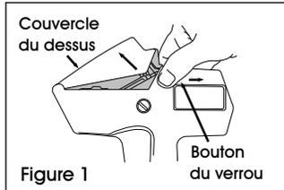
1. Appuyez sur les deux boutons de verrou dans la direction du rouleau d'étiquettes, puis faites pivoter le couvercle du dessus pour dégager la tête d'impression. (Voir Figure 1)
