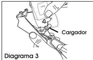
3. Corte el extremo del empaque del rodillo de tinta. Usando el paquete para proteger los dedos, deslice el cargador dentro del empaque y coloque el rodillo de tinta nuevo en su lugar. (Vea Diagrama 3)
