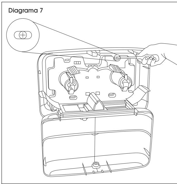
4. Asegúrese de que el despachador esté nivelado mirando la barra niveladora del interior del despachador. Si está nivelado, inserte los tres tornillos restantes. (Vea Diagrama 8)
