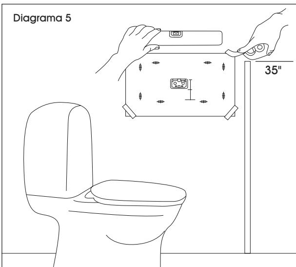
2. Usando una broca de 6 mm, taladre en la pared cerca de 3.81 cm (1½") en cada marca de ubicación de tornillo en la plantilla. (Vea Diagrama 6)
