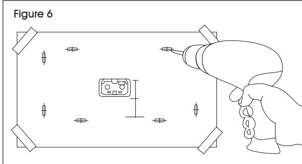
3. Retirez la plaque du mur. Insérez les ancrages muraux (si nécessaire) dans les quatre trous prépercés. Tenez le distributeur contre le mur de sorte que les trous dans le mur et ceux du distributeur s'alignent. Insérez la vis supérieure droite et serrez complètement. (Voir Figure 7)
