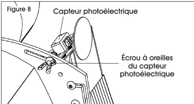
**REMARQUE :** Si le distributeur déroule continuellement des étiquettes sans s'arrêter, le capteur photoélectrique est trop incliné vers le haut et doit être abaissé. (Voir Figure 9)
