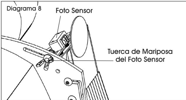
**NOTA:** Si el dispensador despacha etiquetas continuamente y no se detiene, el foto sensor está a un ángulo muy alto y se debe bajar. (Vea Diagrama 9)
